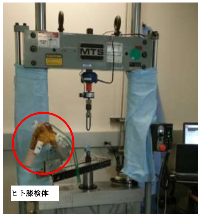
写真4 キャダバーを用いてのバイオメカ実験の様子
